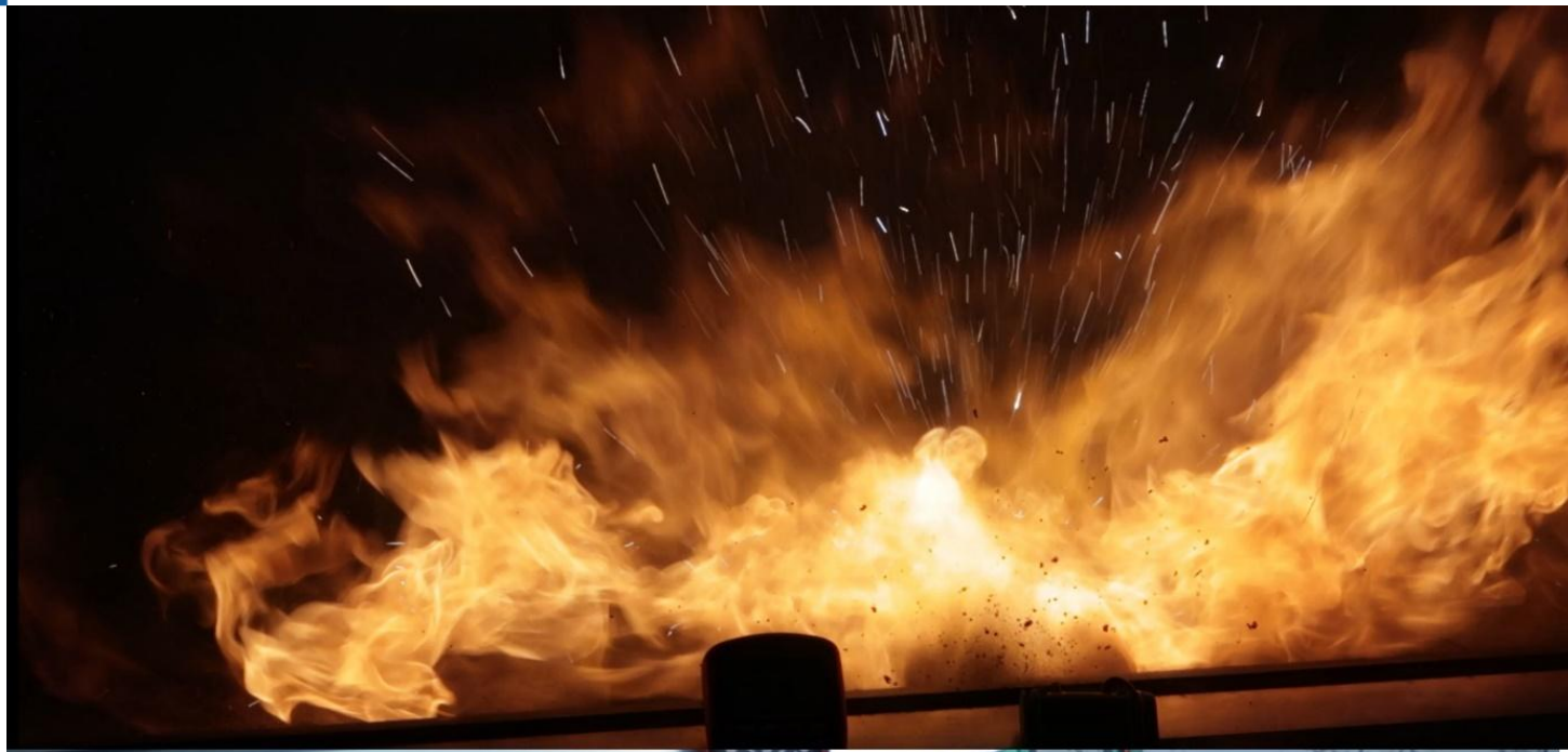
Rycina 4. Sposób palenia się cel akumulatora litowo – jonowego w trakcie testów ogniowych w CNBOP-PIB – przykład 2
