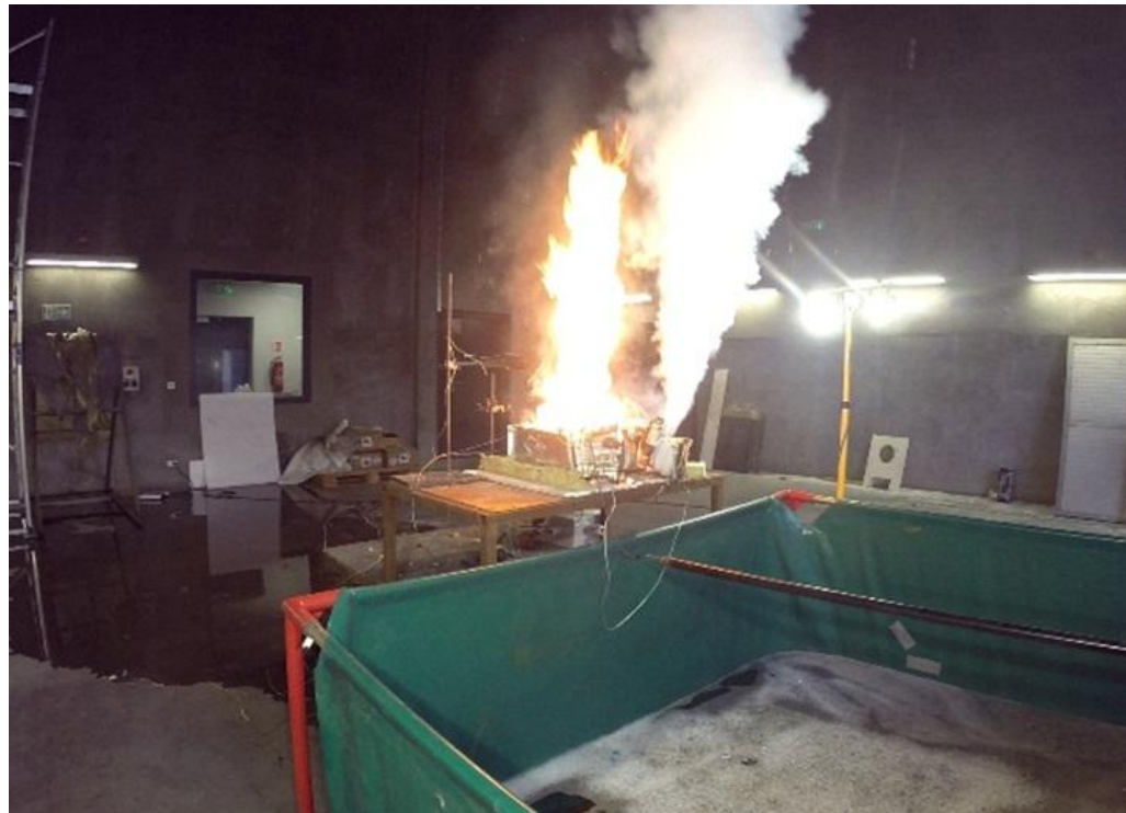
Rycina 3. Sposób palenia się cel akumulatorka litowo – jonowego w trakcie testów ogniowych w CNBOP_PIB – przykład 1
